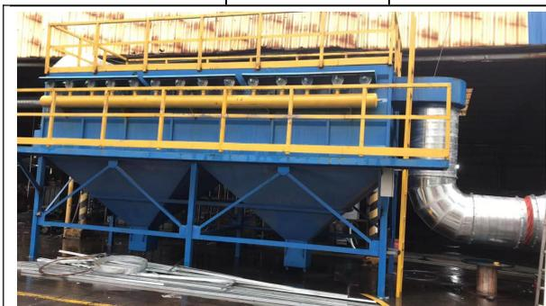
图 1 两器破碎抽条、切割粉尘处理设施
