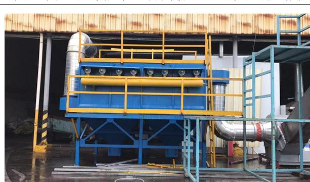
图 4 废偏转线圈破碎粉尘处理设施
